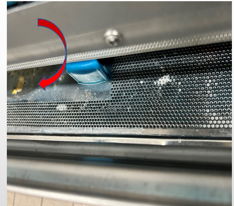
Verschmutzungen im Inneren des Ablaufsieves
