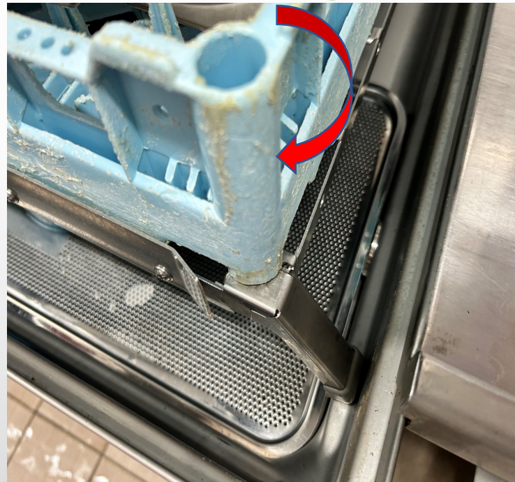
verschlissener und verschmutzter Geschirrspülkorb
