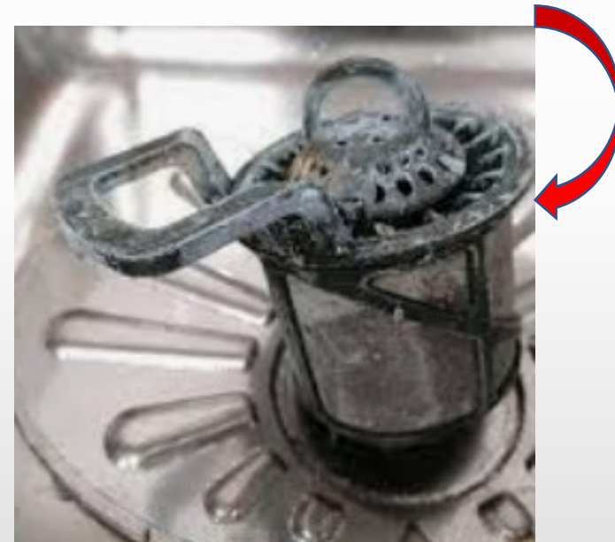
verschmutztes und verkalktes Sieb im handelsüblichen Geschirrspülautomaten
