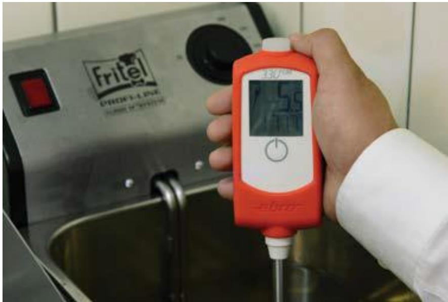
Rühren Sie leicht, bis die Temperatur in der Anzeige ungefähr der Temperatur des Öls entspricht. Dies kann etwa 20 Sekunden dauern.
